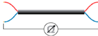
Medición de resistencia de cable.
