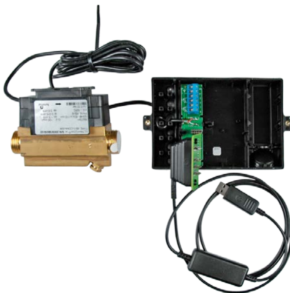
Рис. 45. Положение четырех-контактного коннектора с адаптером для ULTRAFLOW® 14 на ULTRAFLOW® 14/24 (MULTICAL® 61/62).
