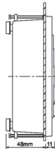
Tafelmontierter MULTICAL® Typ 66-CDE von der Seite gesehen.
