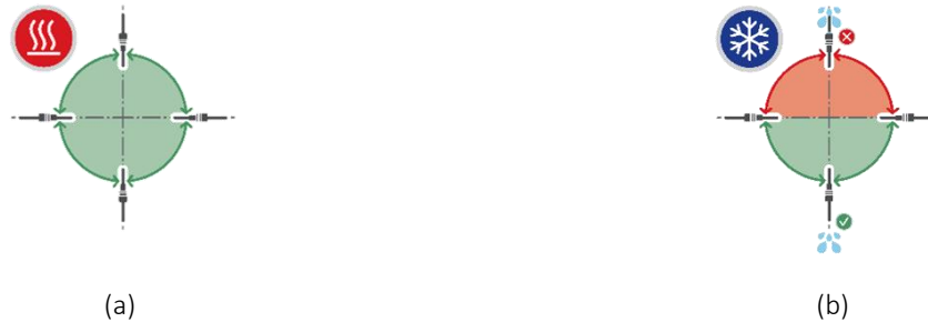
Figur 20. Acceptabel orientering af en temperaturføler i (a) en varme- og (b) en køleinstallation.
