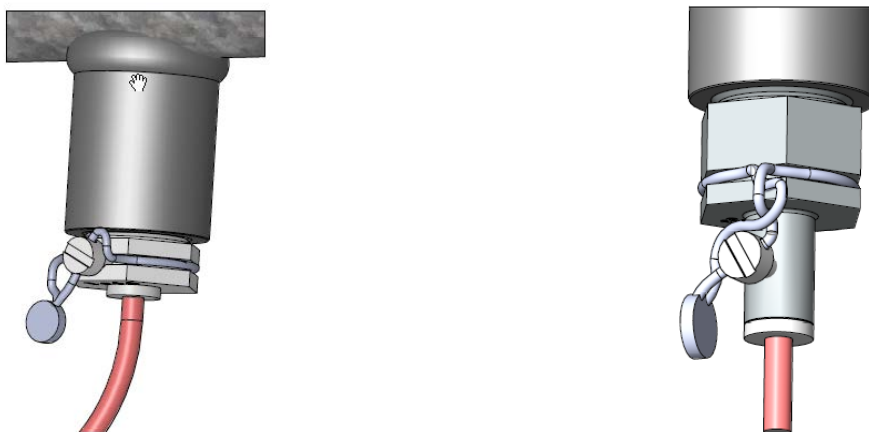
Abb. 25: Mehrere Beispiele für das Plombieren von Temperaturfühlern, entweder mit Plombendraht oder mit Plombierschellen.
