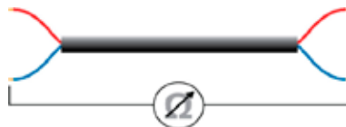
Măsurarea rezistenței cablului.
