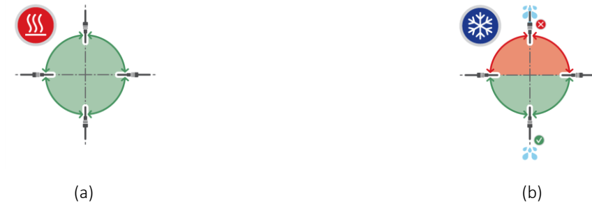
Figur 19. Acceptabel orientering af en temperaturføler i (a) en varme- og (b) en køleinstallation.
