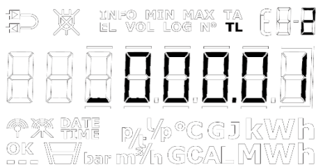
Abb. 20- Einstellung eines positiven TL2 in der "SETUP loop": Der _ blinkt, wenn er auf der Vorzeichenstelle steht, verschwindet aber, wenn auf eine andere Ziffer gewechselt wird.
