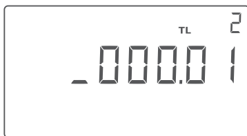
Abb. 20: Einstellung eines positiven TL2 in der "SETUP loop": Der _ blinkt, wenn er auf der Vorzeichenstelle steht, verschwindet aber, wenn auf eine andere Ziffer gewechselt wird.
