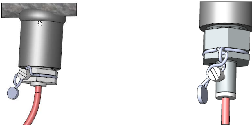
Figur 25: En række eksempler på plombering af temperaturfølere, enten med plombetråd eller plomberingskaller.
