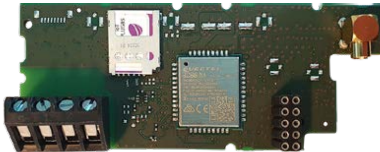
SIM-kort monteret på modulet
