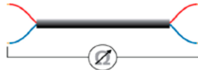
Medición de resistencia de cable.
