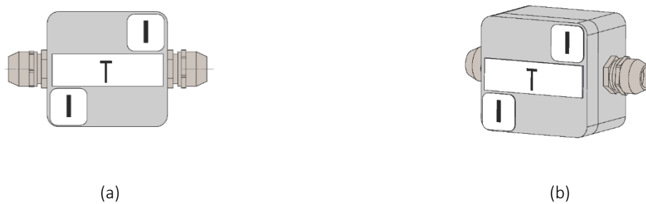
Abb. 63. Plombierung von Cable Extender Box von vorne (a) und von der Seite (b) aus gesehen.
