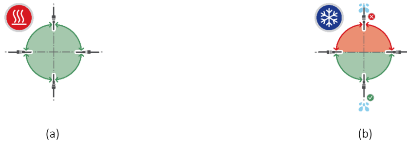
Abb. 20. Akzeptable Orientierung eines Temperaturfühlers in (a) einer Wärme- und (b) einer Kälteinstallation.
