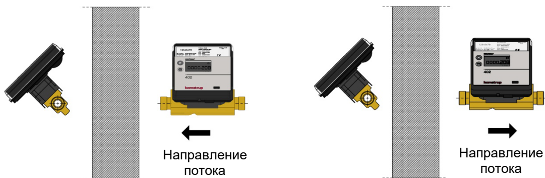
Рис. 11: Монтаж счетчика с резьбовым присоединением
