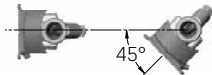
Figur 7: Ved små og mellemstore ULTRAFLOW® ( \leq DN100) skal elektronikboksen være monteret på siden og må maksimalt drejes -45^\circ i forhold til rørraksen
