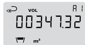
Figur 10: Målerens aktuelle tællestand kan, vha. PC-programmet METERTOOL, indlægges som startværdi i MULTICAL®, sådan at opsummeringerne foretages synkront.
