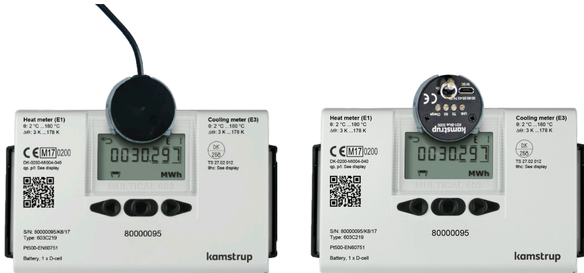
Figur 20: USB optisk læsehoved og Bluetooth optisk læsehoved placeret korrekt på måleren
