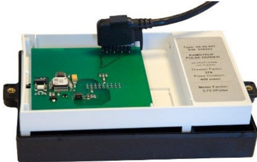
Figur 61. Korrekt placering af kommunikationsenheden i Pulse Divider 66-99-607.
