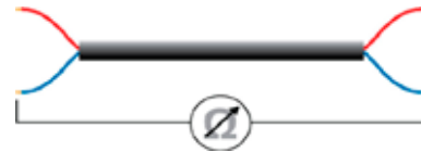
Måling af kabelmodstand.
