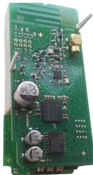
Bilde 3. Jordfeilmodul og OMNICON MUC-modul.
