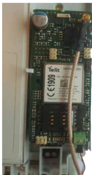
Bilde 23. Måler med jordfeilmodul og OMNICON 2G MODEM.
