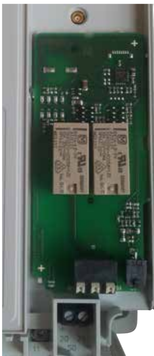
Bilde 18. Montering av jordfeilmodul i måler.
