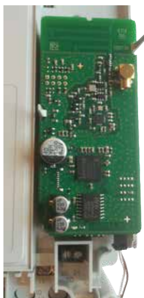
Bilde 16. Måler monteret med jordfeilsmodul og OMNICON MUC-modul.
