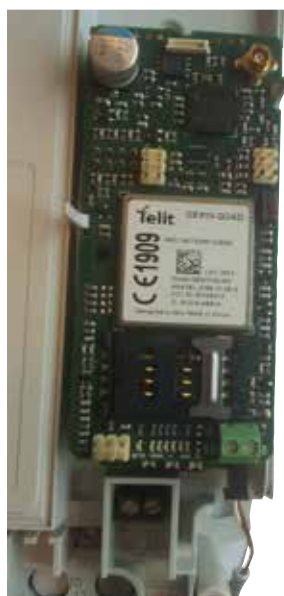
Bilde 14. Måler monteret med jordfeilmodul og OMNICON 2G MODEM.
