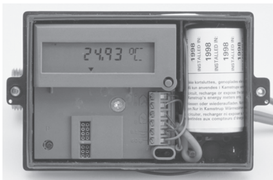
MULTICAL® Compact con batería de litio de célula D.
