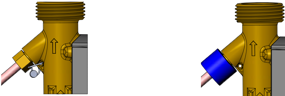
Ejemplo de sellado de una sonda de temperatura directa corta montada en un caudalímetro
