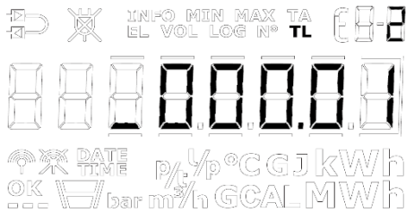
Figur 20 – Indstilling af positiv TL2 i SETUP-loopet, _ blinker, når markøren er på tegnets position, men forsvinder, når der flyttes til et andet ciffer.
