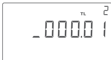
Figur 20: Indstilling af positiv TL2 i SETUP-loopet, _ blinker, når markøren er på tegnets position, men forsvinder, når der flyttes til et andet ciffer.
