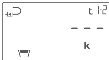
Visning af temperaturdifferens t1-t2 ved temperaturfølerfejl
