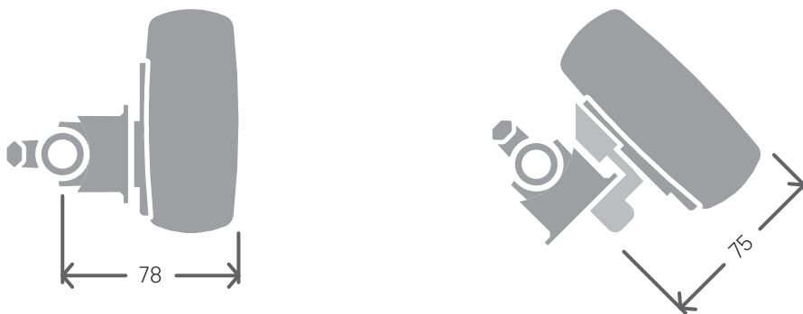
Abb. 5: MULTICAL® 603 montiert auf ULTRAFLOW® mit G \frac{3}{4} Gewindeanschluss
