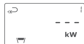
Fehler in der Leistungsanzeige in Folge eines Temperaturfühlerfehlers.
