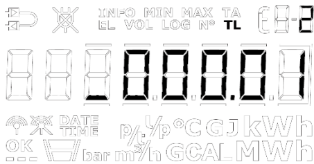
Abb. 21 - Einstellung eines positiven TL2 in der "SETUP loop": Der _ blinkt, wenn er auf der Vorzeichenstelle steht, verschwindet aber, wenn auf eine andere Ziffer gewechselt wird.
