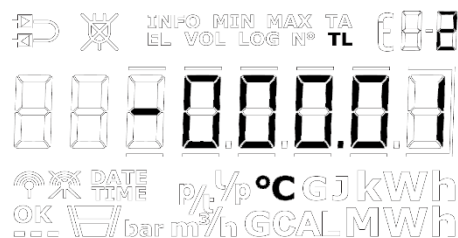
Abb. 22 - Einstellung eines negativen TL2 in der "SETUP loop": Das - blinkt, wenn es auf der Vorzeichenstelle steht, und bleibt eingeschaltet, wenn auf eine andere Ziffer gewechselt wird.
