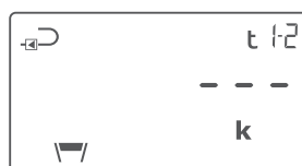
Anzeige der Temperaturdifferenz t1-t2 bei Temperaturfühlerfehlern.
