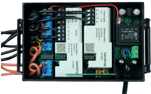
Wireless M-Bus-Modul mit eingebauter interner Antenne
