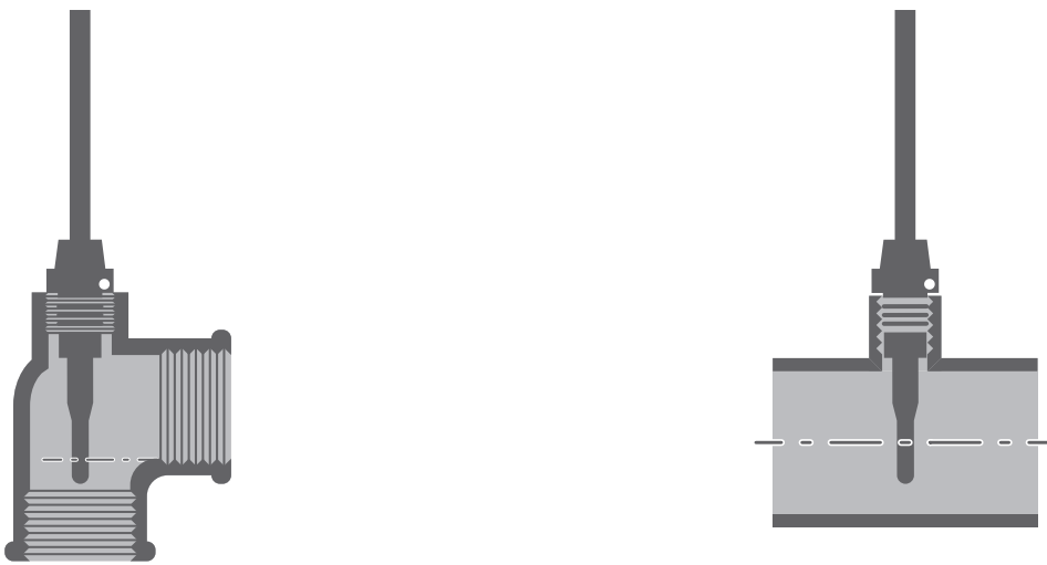
Abb. 12: Beispiele für die Montage der Tauchhülse für den Temperaturfühler \varnothing 5,8 mm mit R\frac{1}{2} -Gewinde (links) und der Tauchhülse für den Temperaturfühler \varnothing 6,0 mm mit G\frac{1}{2} -Gewinde und Kupferdichtung (rechts).
