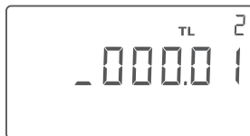
Abb. 19: Einstellung eines positiven TL2 in der "SETUP loop": Der _ blinkt, wenn er auf der Vorzeichenstelle steht, verschwindet aber, wenn auf eine andere Ziffer gewechselt wird.
