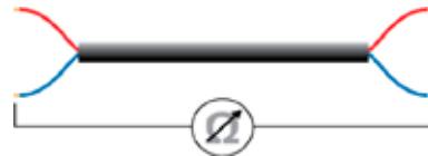
Messung des Kabelwiderstands.
