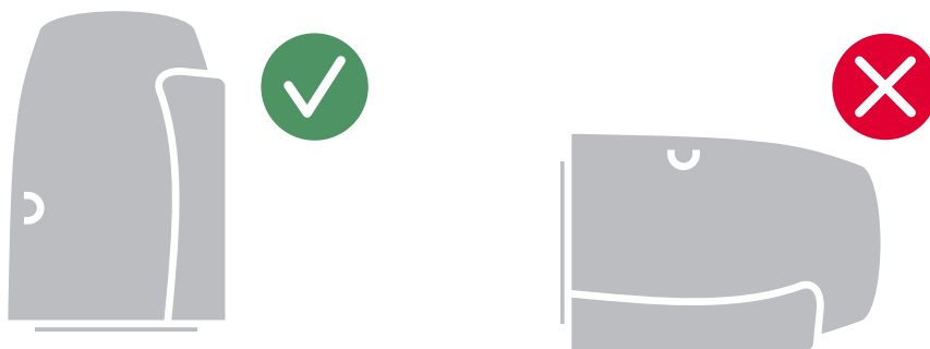
Abb. 4 – READy 4G Bridge-Ausrichtung
