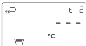
Visning af t2 ved temperaturfølerfejl
