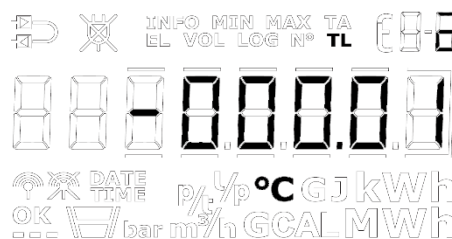
Figur 20 – Indstilling af negativ TL2 i "SETUP loop", - blinker, når markøren er på tegnets position og forbliver tændt, når der flyttes til et andet ciffer.
