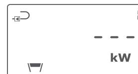
Fejl i effektvisning som følge af temperaturfølerfejl
