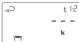
Visning af temperaturdifferens t1-t2 ved temperaturfølerfejl
