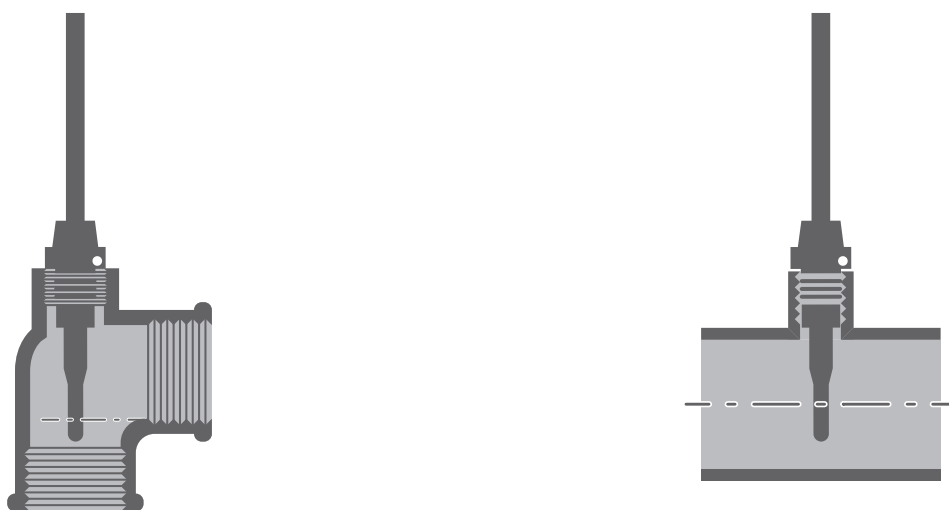
Figur 12: Eksempler på installation af følerlomme til \varnothing 5,8 mm temperaturføler med R\frac{1}{2} gevind (til venstre) og følerlomme til \varnothing 6,0 mm temperaturføler med G\frac{1}{2} gevind og kobberpakning (til højre).
