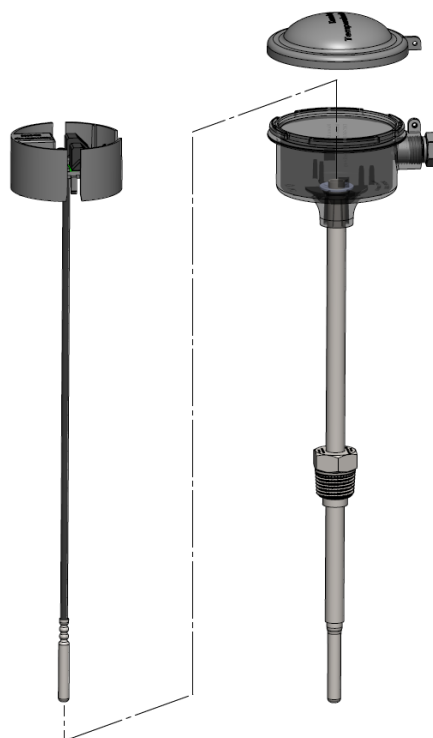
Figur 13: En \varnothing 5,8 mm lømmeføler med tilslutningshoved kan f.eks. monteres i et T-stykke som vist på Figur 14.
