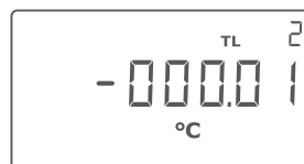
Figur 20: Indstilling af negativ TL2 i "SETUP loop", - blinker, når markøren er på tegnets position og forbliver tændt, når der flyttes til et andet ciffer.
