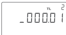
Figur 19: Indstilling af positiv TL2 i "SETUP loop", _ blinker, når markøren er på tegnets position, men forsvinder, når der flyttes til et andet ciffer.
