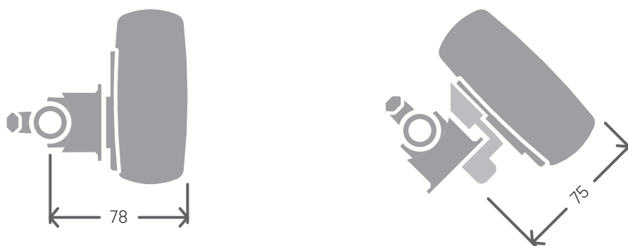
Figur 5: MULTICAL® 603 monteret på ULTRAFLOW® med G¼ gevindtilslutning
