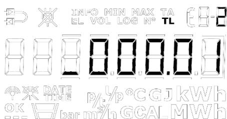
Figur 19 – Indstilling af positiv TL2 i "SETUP loop", _ blinker, når markøren er på tegnets position, men forsvinder, når der flyttes til et andet ciffer.
